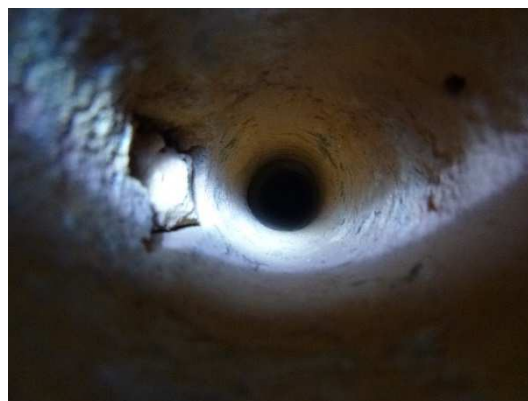
Figura 4: foro guida per l'esecuzione dell'indagine endoscopica della parete ID E1.
