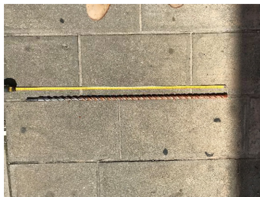
Figura 11: valutazione della quota di imposta dell'opera di fondazione.
