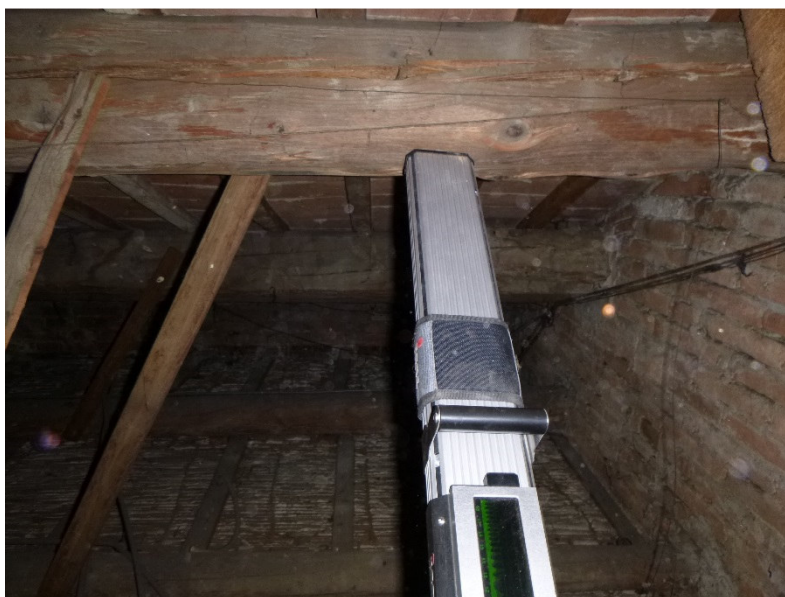
Figura 4 prova resistografica su trave
