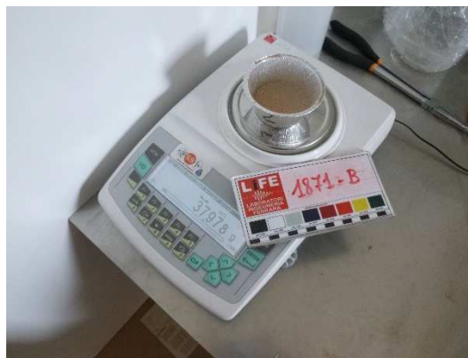
Figura 9: peso del campione "secco" a conclusione della prova sperimentale, e conseguente stima dell'umidità del campione.
