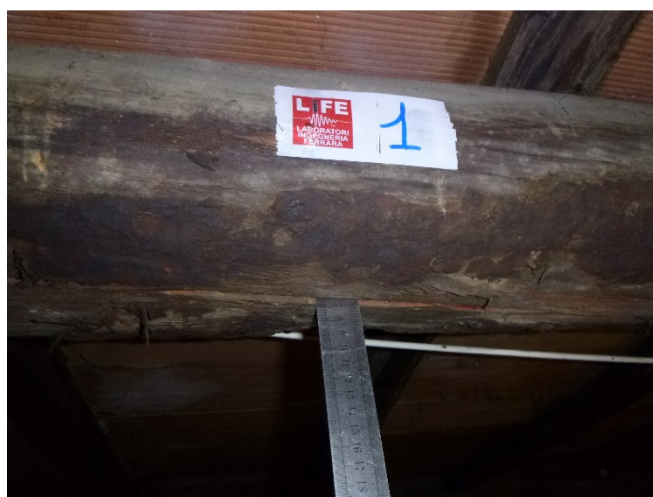
Figura 3 rilievo dei parametri per l'assegnazione a categoria di resistenza secondo UNI 11119
