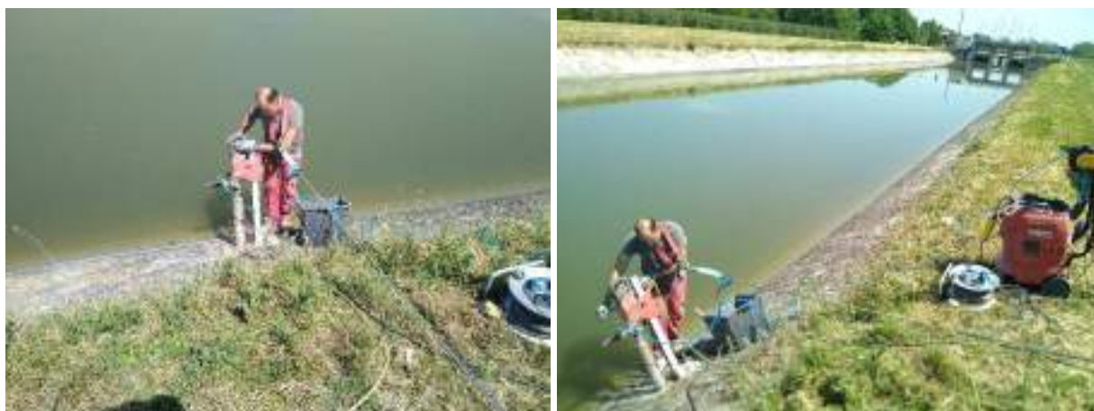
Figura 6: prelievo campioni di calcestruzzo – Id 4 e Id 4G
