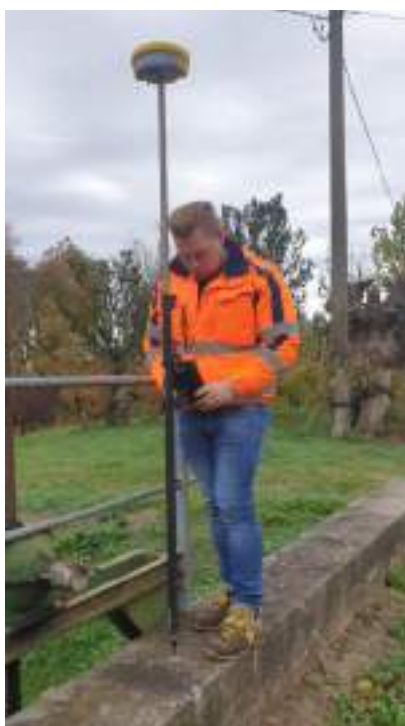
Foto 07 – Rilievo GNSS con ricevitore serie Geomax Zenith 25 Pro dei caposaldi di riferimento
