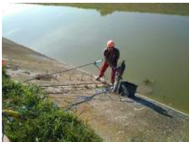
Figura 3: prelievo campioni di calcestruzzo – Id 1 e Id 1G
