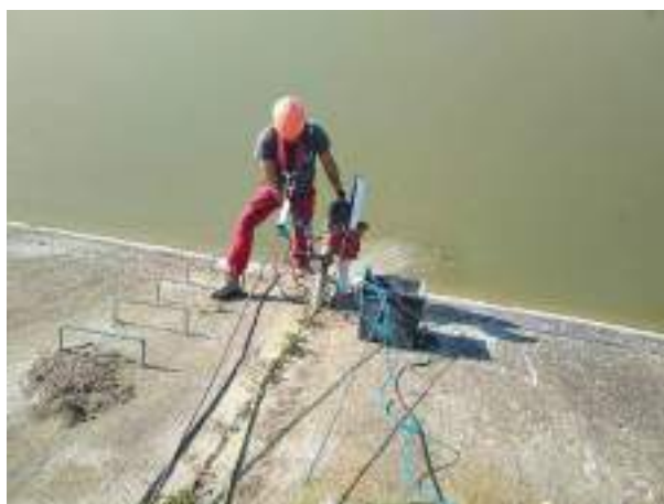
Figura 3: prelievo campioni di calcestruzzo – Id 1 e Id 1G
