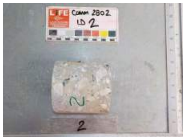
Figura 23: preparazione dei provini da sottoporre a prova di rottura per compressione– ID2
