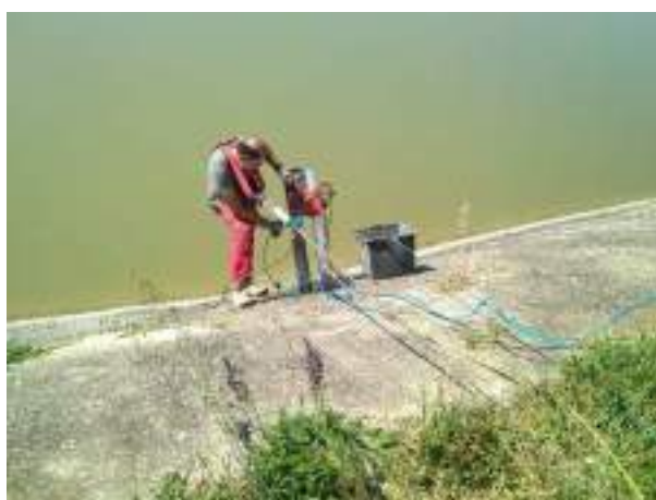
Figura 5: prelievo campioni di calcestruzzo – Id 3 e Id 3G
