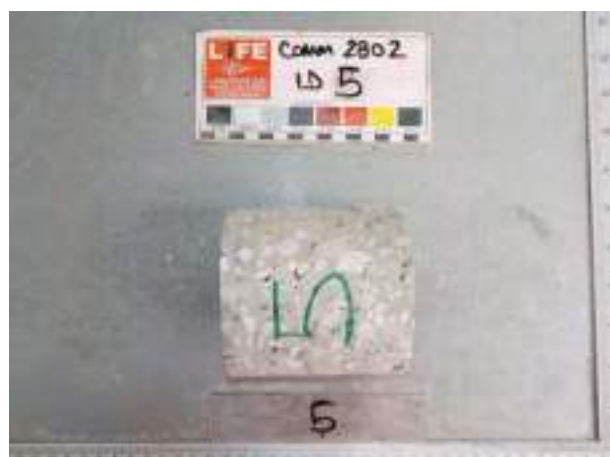
Figura 25: preparazione dei provini da sottoporre a prova di rottura per compressione – ID5
