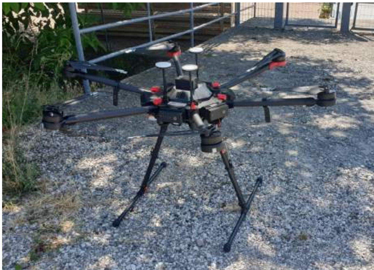
Foto 01 – Sistema Aeromobile a Pilotaggio Remoto (UAS) utilizzato per il rilievo – Matrice 600 PRO DJI
