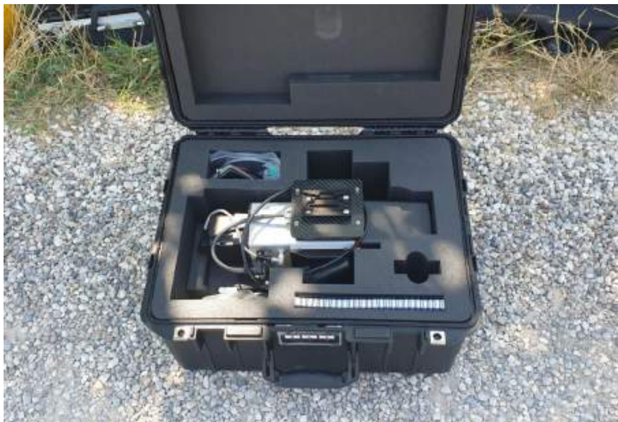
Foto 02 – Sensore lidar utilizzato per il rilievo - MINI-VUX Riegl
