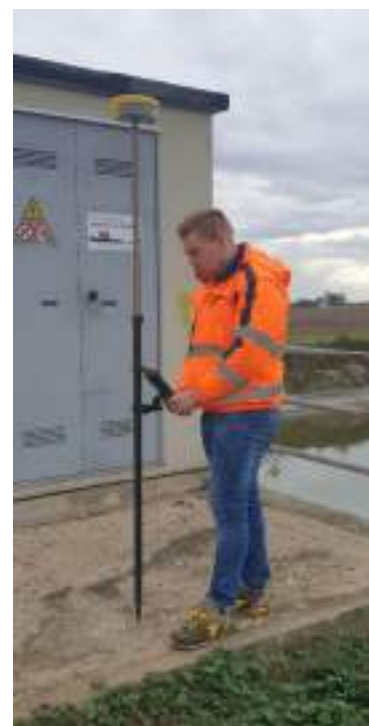
Foto 07 – Rilievo GNSS con ricevitore serie Geomax Zenith 25 Pro dei caposaldi di riferimento
