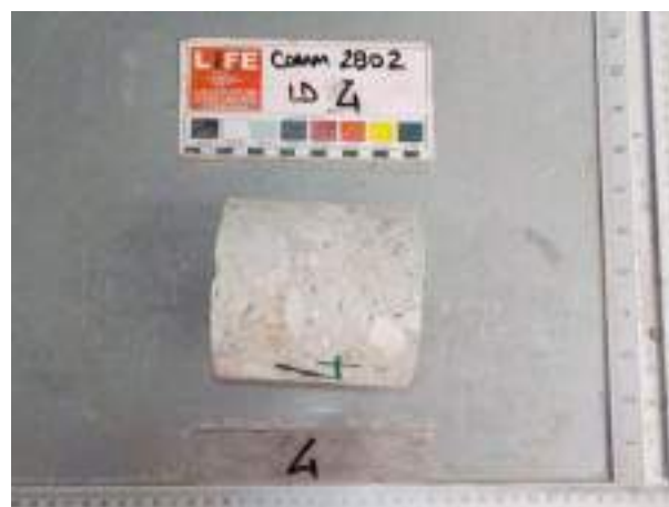
Figura 24: preparazione dei provini da sottoporre a prova di rottura per compressione – ID4
