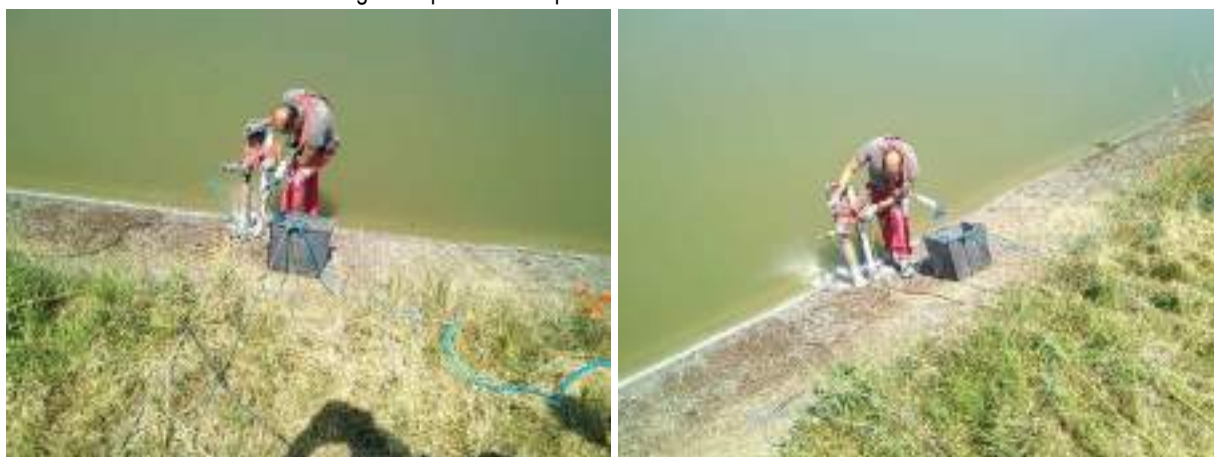
Figura 7: prelievo campioni di calcestruzzo – Id 5 e Id 5G
