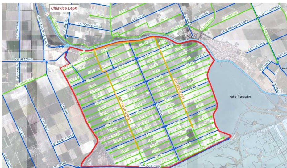
Figura 7. Adduttori irrigui della Valle Pega (colore arancione), rete di scolo in colore blu e di distribuzione irrigua in colore verde.
